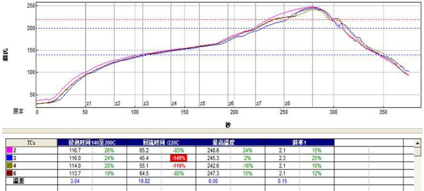
图片14 回流焊焊接温度曲线图
