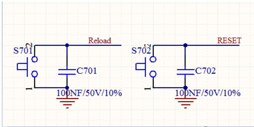
图片13 Reload 和 Reset 设置控制电路图
